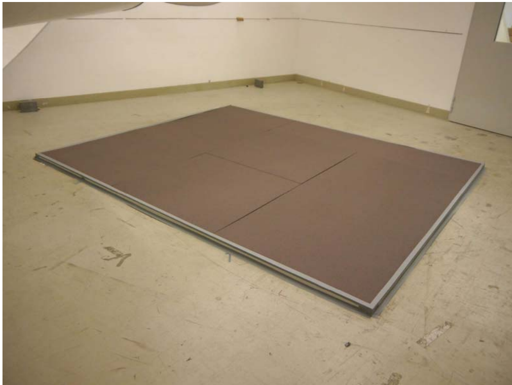
Abbildung B.1. Prüfaufbau des Wandpaneeles als flächiger Absorber im Hallraum.
